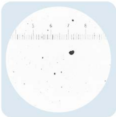
ISO 4406 Livello 20/18/15 SAE AS4059 Tabella 1 Livello 9 NAS 1638 Livello 9 SAE AS4059 Tabella 2 Livello 10A/9B/9C
