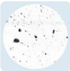
NAS 12 ISO 23/21/18 Tipicamente nuovo olio consegnato nel nuovo acciaio temperato certificato a 205 litri in barili
