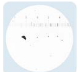
NAS 6 ISO 17/15/12 Tipicamente richiesto per la maggior parte dei sistemi oleodinamici moderni
