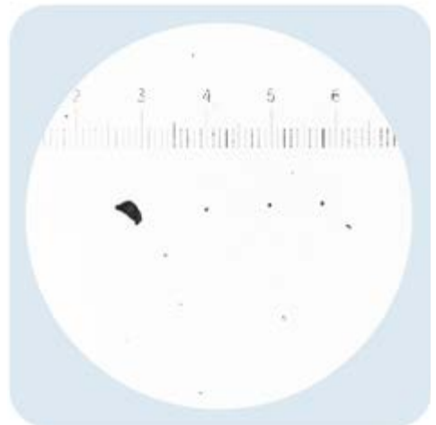
ISO 4406 Livello 17/15/12 SAE AS4059 Tabella 1 Livello 6 NAS 1638 Livello 6 SAE AS4059 Tabella 2 Livello 7A/6B/6C
