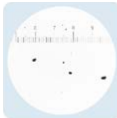
NAS 7 ISO 18/15/13 Classe de pollution typique pour une huile neuve, livrée en mini futs neufs certifiés.
