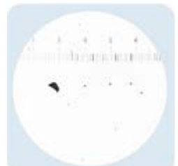
NAS 6 ISO 17/15/12 Classe de pollution requise pour la plupart des systèmes hydrauliques modernes.
