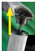
Retirer la coupelle bypass ou borgne
