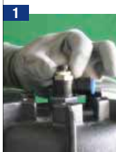
Desserrer l'écrou de purge d'air
