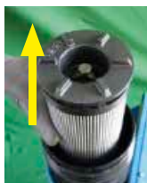
Retirer l'élément filtrant
