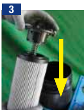
Insérer la coupelle bypass ou la coupelle borgne dans l'élément filtrant
