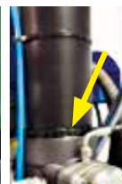
S'assurer que la cuve est bien serrée
