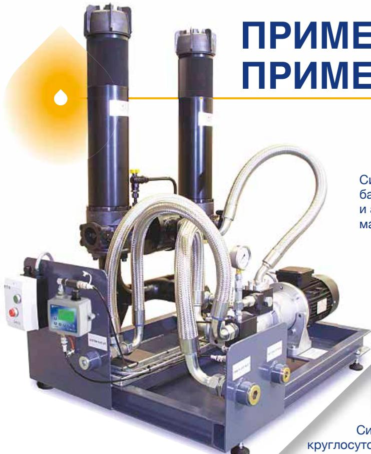
Система фильтрации бака с блоком управления и анализатором чистоты масла
