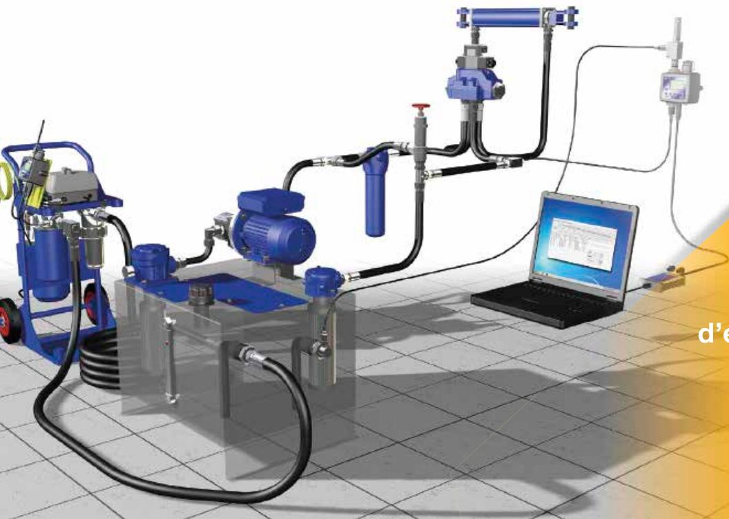
Pour maintenir la propétés du fluide, l'utilisation de filtres est essentielle afin d'éliminer les particules contenues dans le système.
