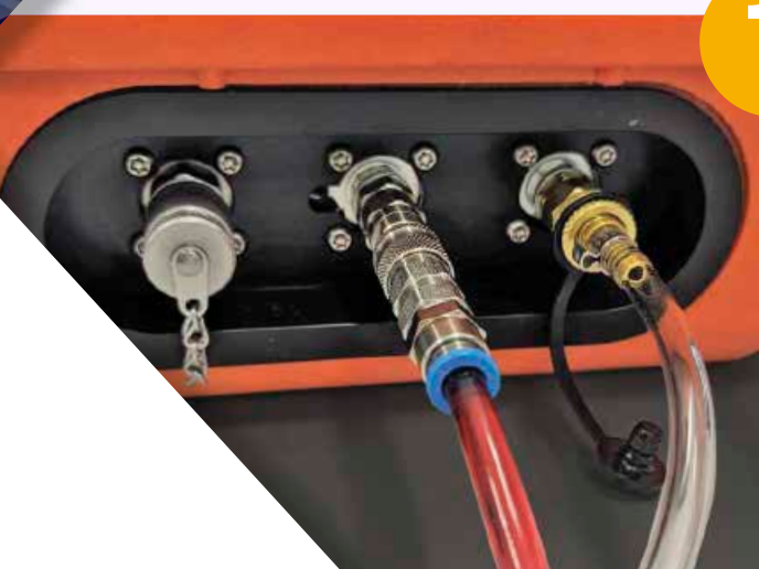
Connexion d'aspiration et sortie d'évacuation branchées
