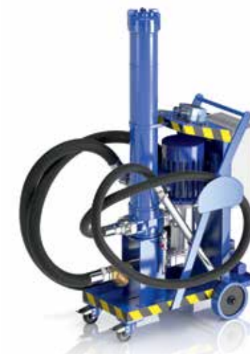
Unità di filtrazione mobile UFM 181. Portata massima 180 l/min, pressione massima 10 bar, motore elettrico trifase 2 poli - 4 kW.
