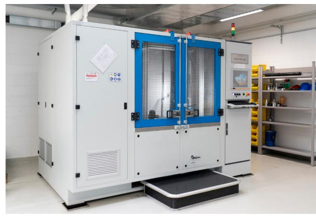
Banco prova Flow Fatigue per la prova di verifica della resistenza a fatica dell'elemento filtrante mediante l'utilizzo di contaminante solido
