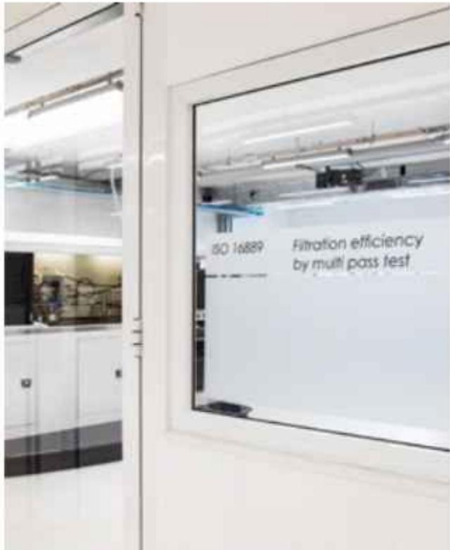
da particelle solide presenti negli oli in esame. Svolte per verificare le caratteristiche dei filtri, le prove sono effettuate in accordo con gli standard internazionali all'interno di camere a clima controllato e filtrato, riproducendo le condizioni operative di pressione e portata di qualsiasi circuito oleodinamico.
