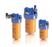
che permettono all'olio di entrare con flusso a spirale e di propagarsi meglio all'interno dell'elemento filtrante. La scelta di utilizzare l'alluminio per la realizzazione della testata ed un nylon rinforzato per il contenitore, ha ridotto il peso complessivo di almeno del 10% rispetto ai precedenti Spin-On.
