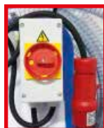
Quadro elettrico trifase
