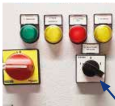
Variateur de phase uniquement sur les versions avec compteur de particules ICM2.0
