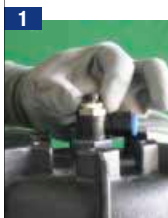
Desserrer l'écrou de purge d'air
