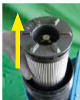
Retirer l'élément filtrant
